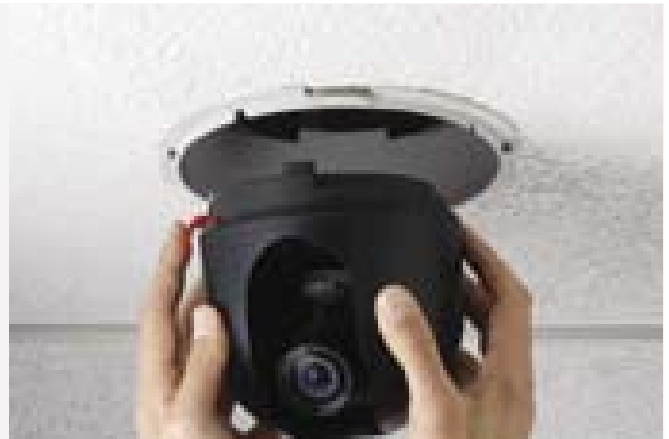
retirar o módulo de câmara fixa 'hot swap' (troca em funcionamento)...
